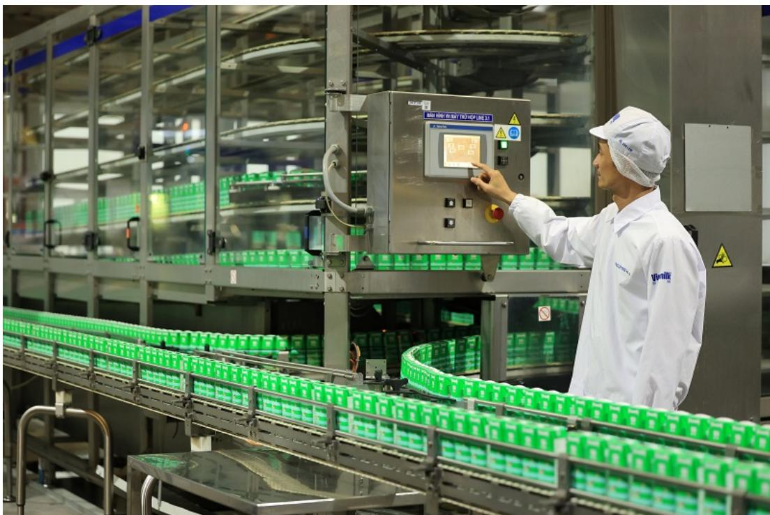
Toàn b? dây chuy?n s?n xu?t, ?óng h?p ??u ???c t? ??ng hóa, l?p trình và theo dõi trên h? th?ng máy tính. ??c bi?t, dây chuy?n có kh? n?ng phát hi?n và lo?i b? các h?p s?n ph?m không ??t quy cách, tiêu chu?n tr??c khi ???c ?óng vào các thùng thành ph?m.
