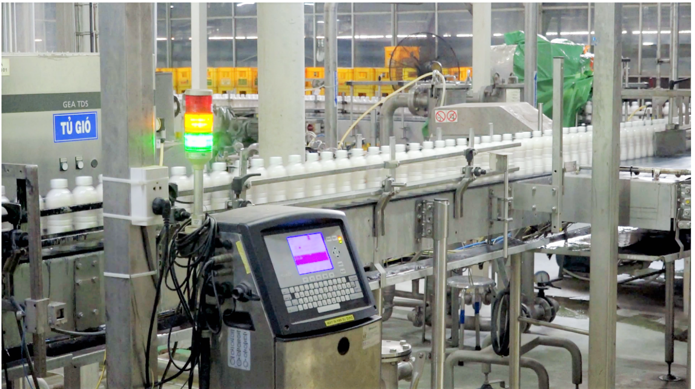
Dây chuyền chiết lạnh vô trùng Aseptic sản xuất sữa đậu nành Number 1 Soya Canxi
